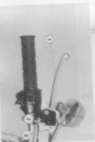
1. Leva frizione 2. Controldado zigrinato 3. Controldado
