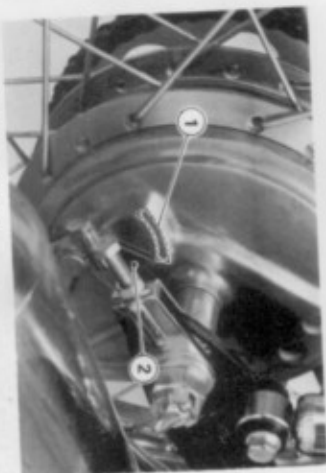
1. Leva frizione 2. Controldado zigrinato 3. Controldado
